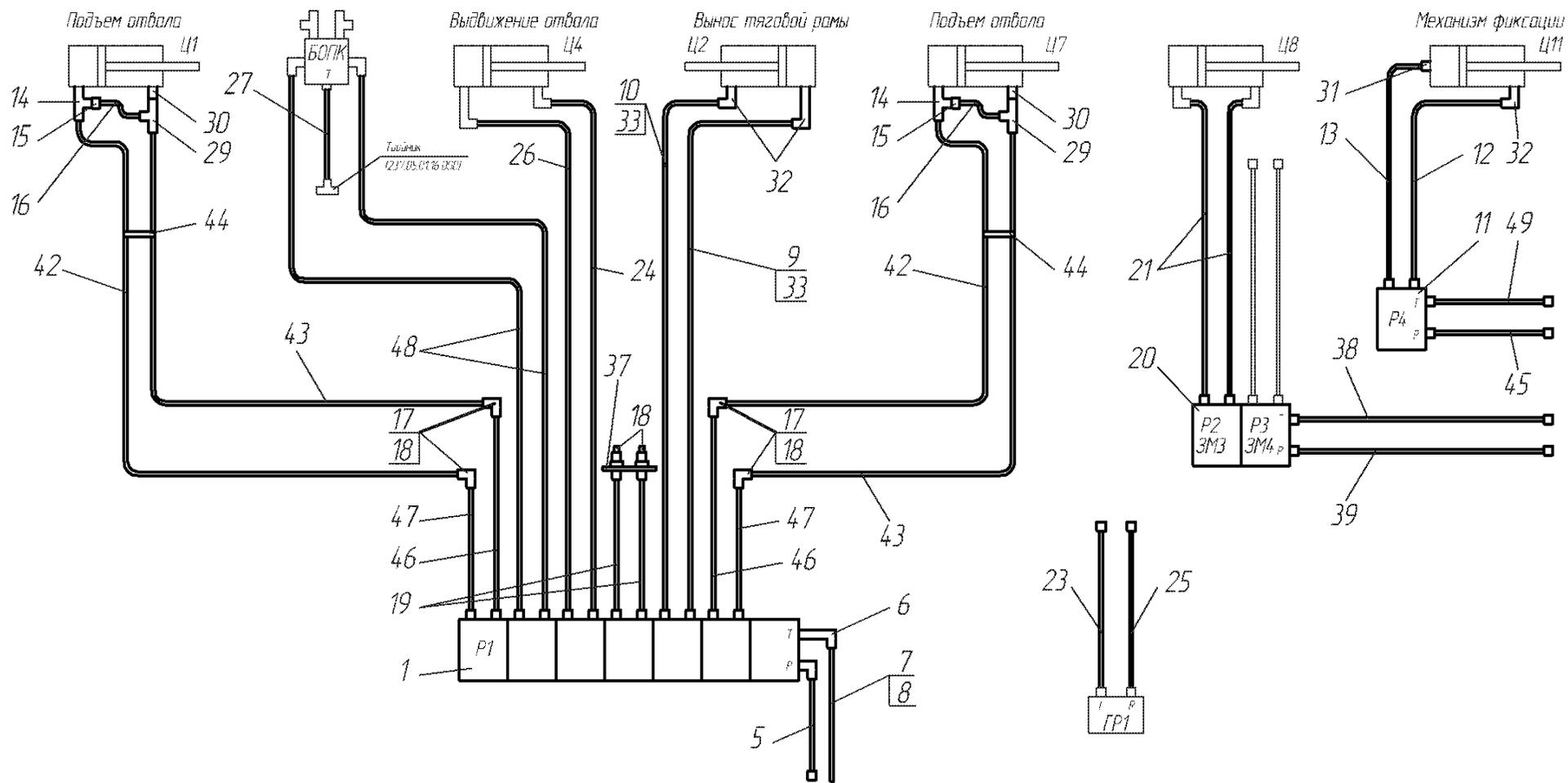
Рис. 28.3 Схема гидравлическая соединений 753.05.03.00.000 Г4
