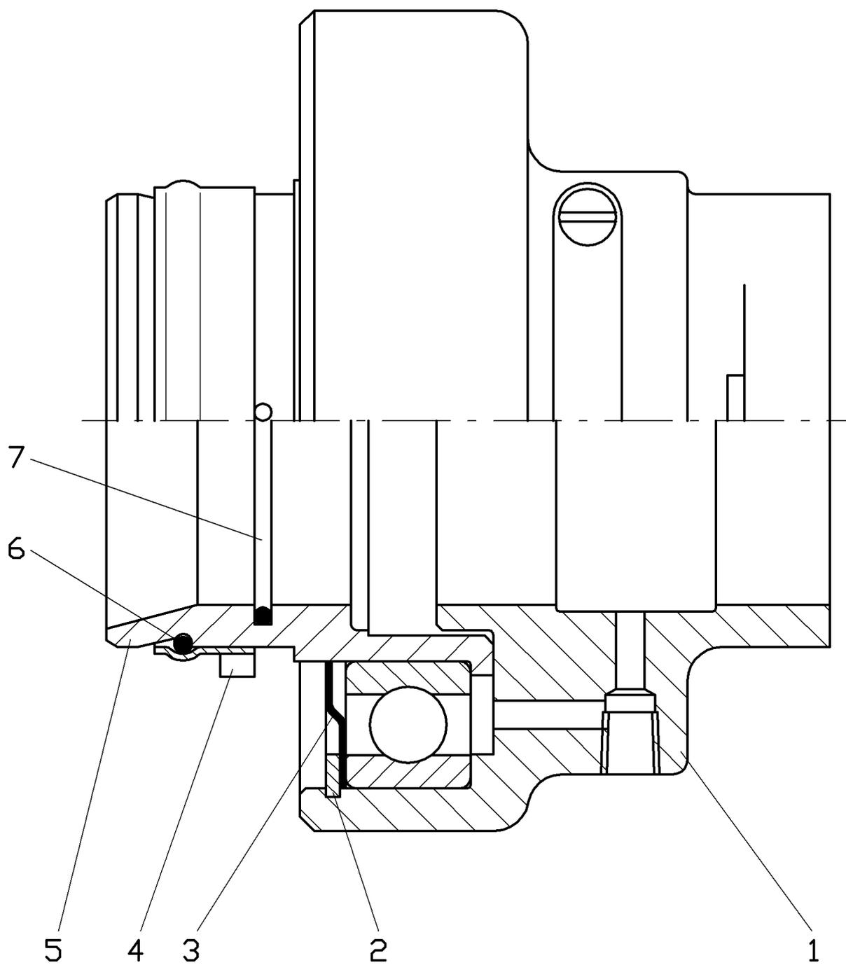
Рис.47 Муфта выключения сцепления 237.03.06.00.000
