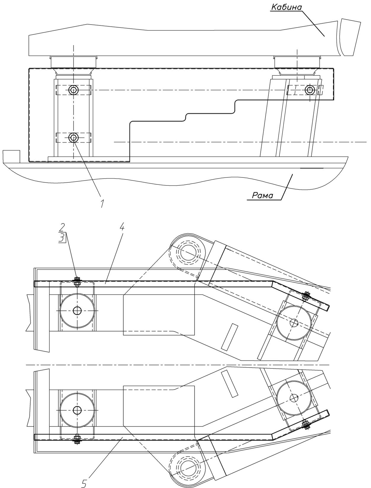
Рис.44 Установка фальшпанелей 752.15.00.00.000
