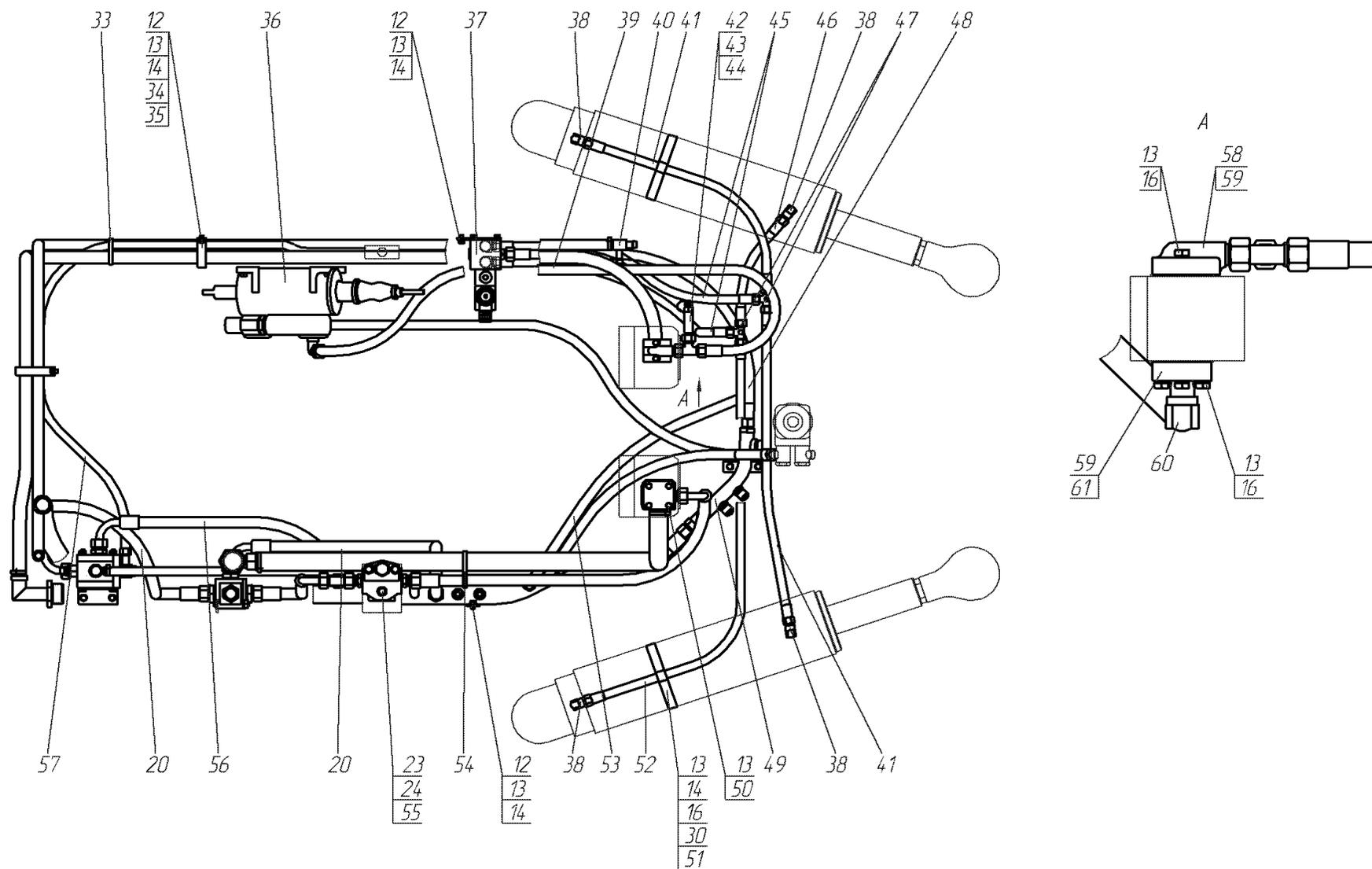
Рис.27.2 Гидросистема рамы подмоторной 752.05.01.00.000
