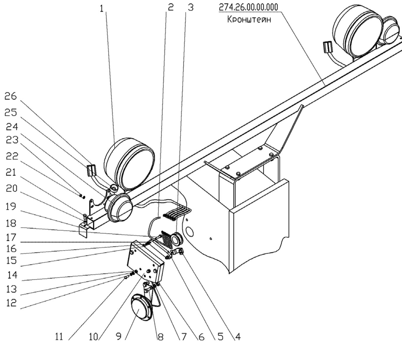
Рис. 16.17 Установка передних осветительных и электрических приборов
