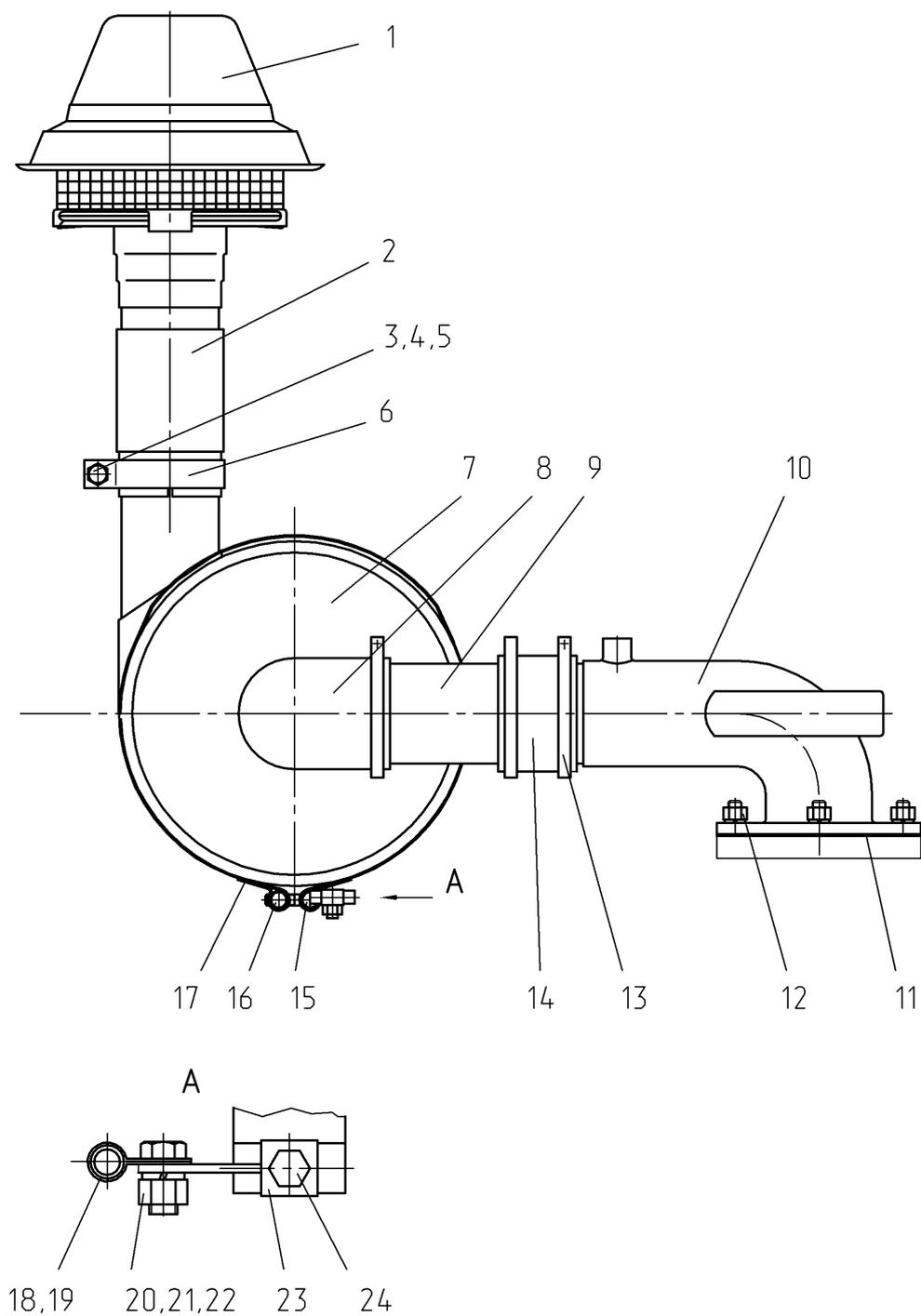
Рис. 36 Установка воздухоочистителя 237.02.04.00.000
