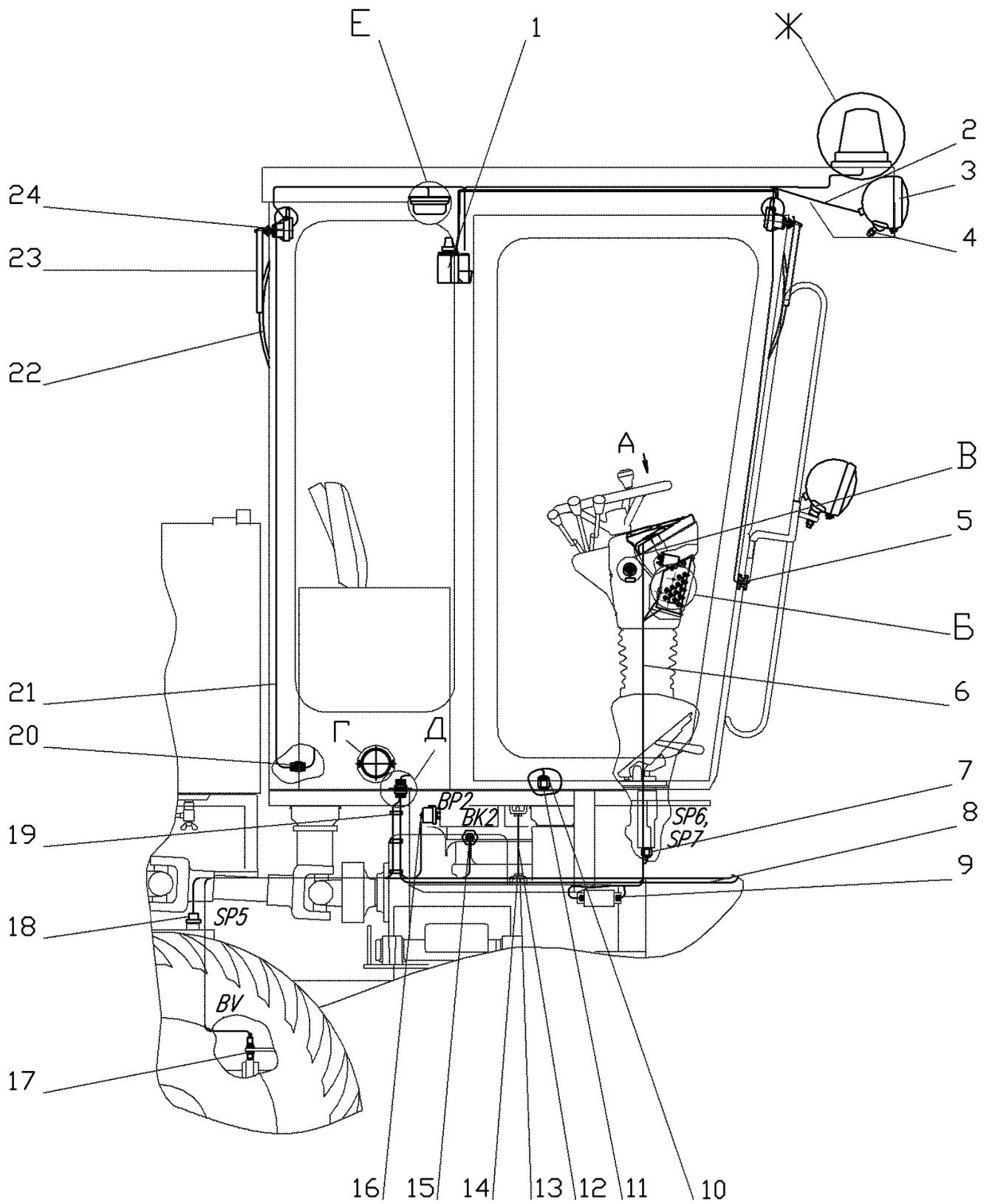
Рис. 16.4 Электрооборудование кабины
