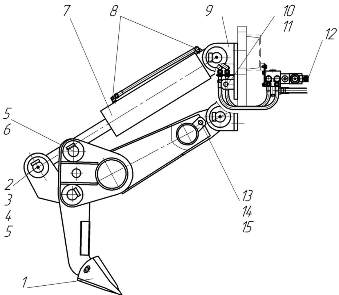
Рис. 10.1 159.19.00.00.000-02 Установка рыхлителя
