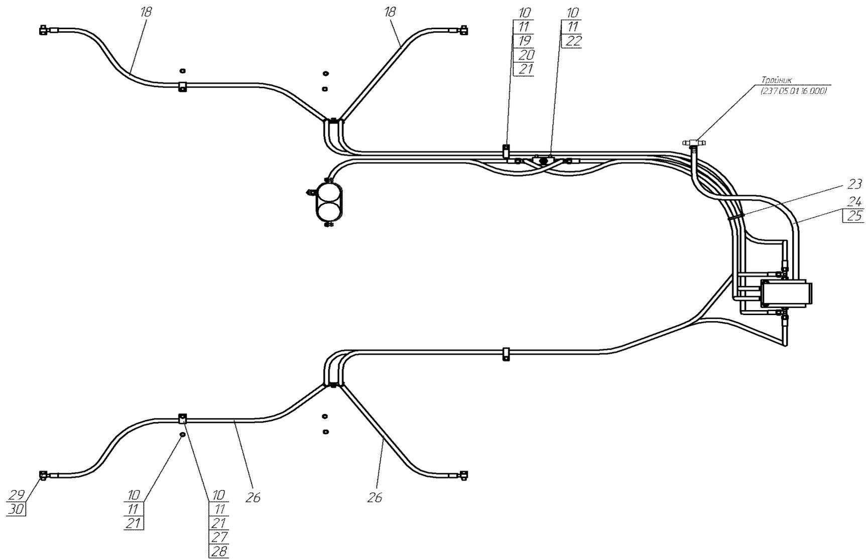
Рис. 30.2 Гидросистема тормозов 752.11.00.00.000
