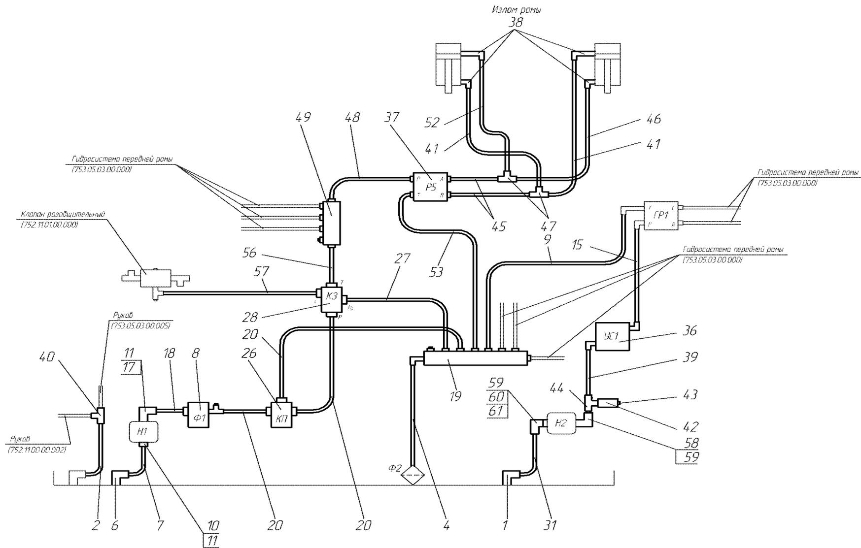
Рис. 27.3 Схема гидравлическая соединений 752.05.01.00.000 Г4
