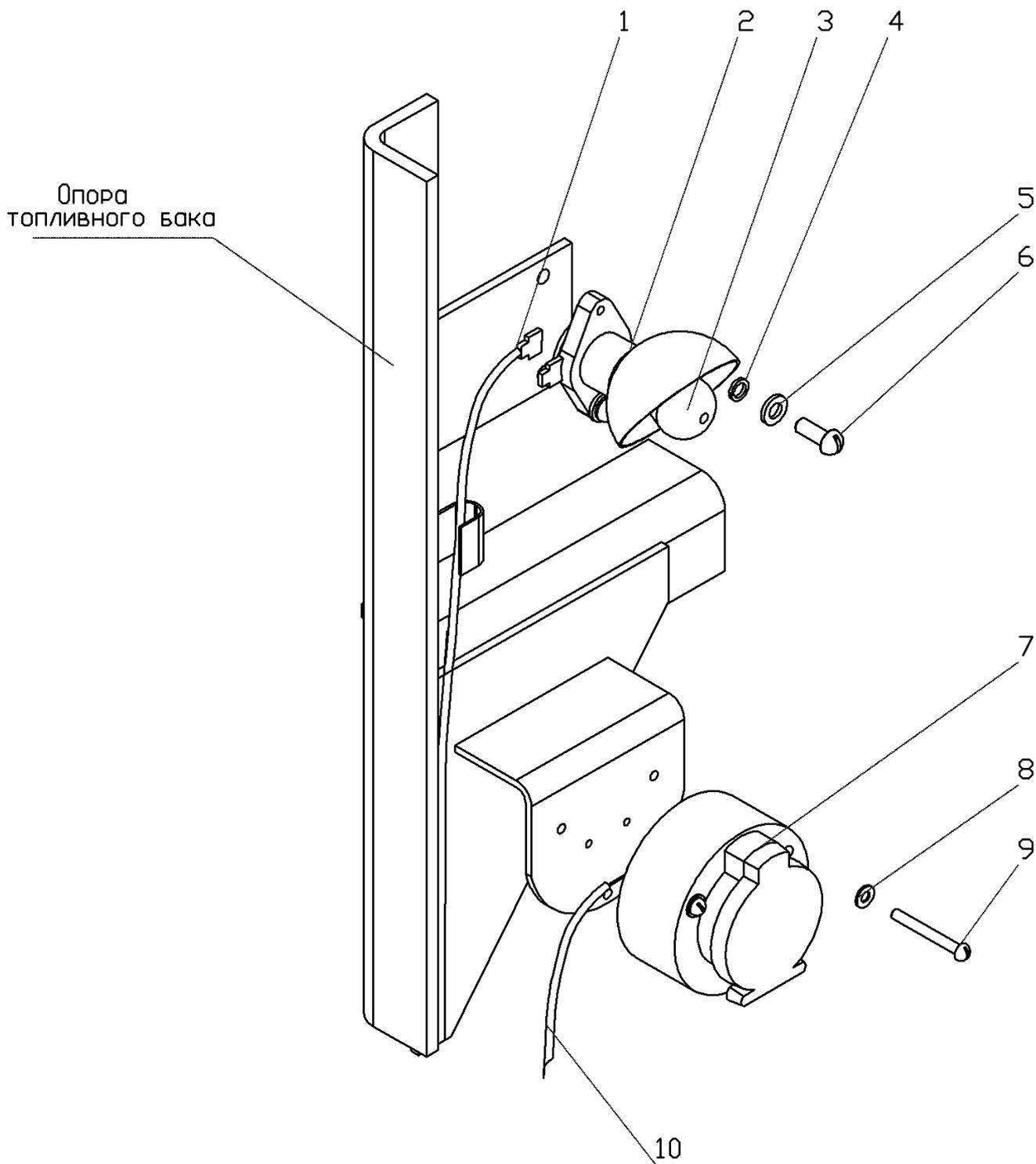
Рис. 16.16 Установка лампы подкапотной и розетки
