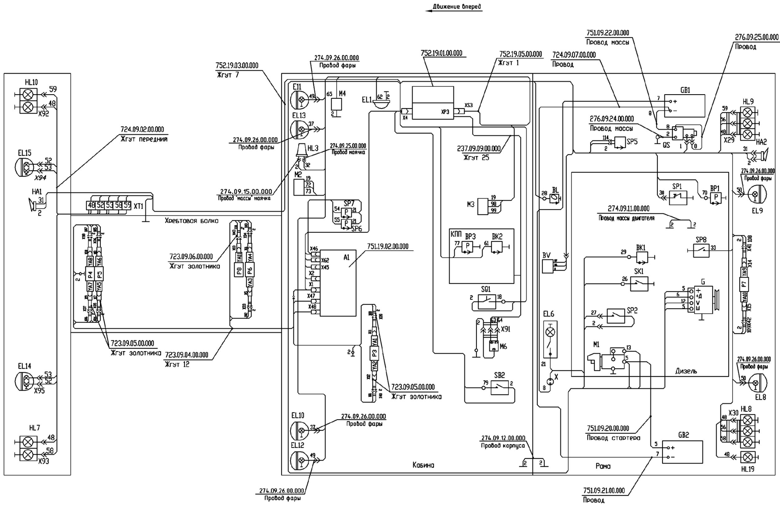
Рис. 16.3 752.19.00.00.000Э4 Схема соединений
