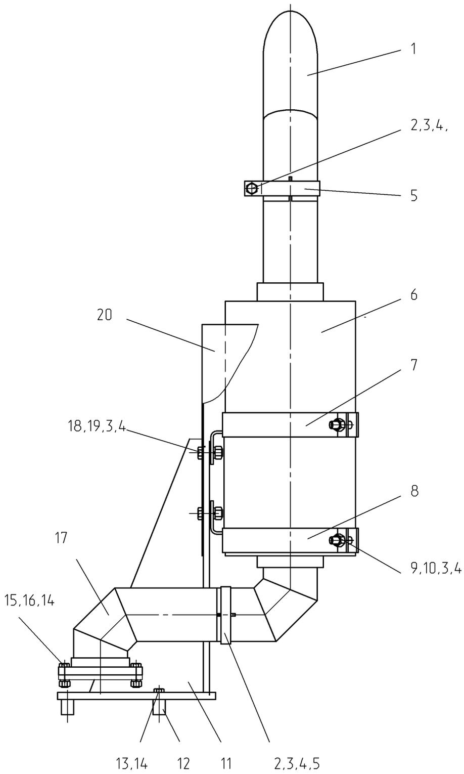
Рис. 35 Установка глушителя 237.02.03.00.000
