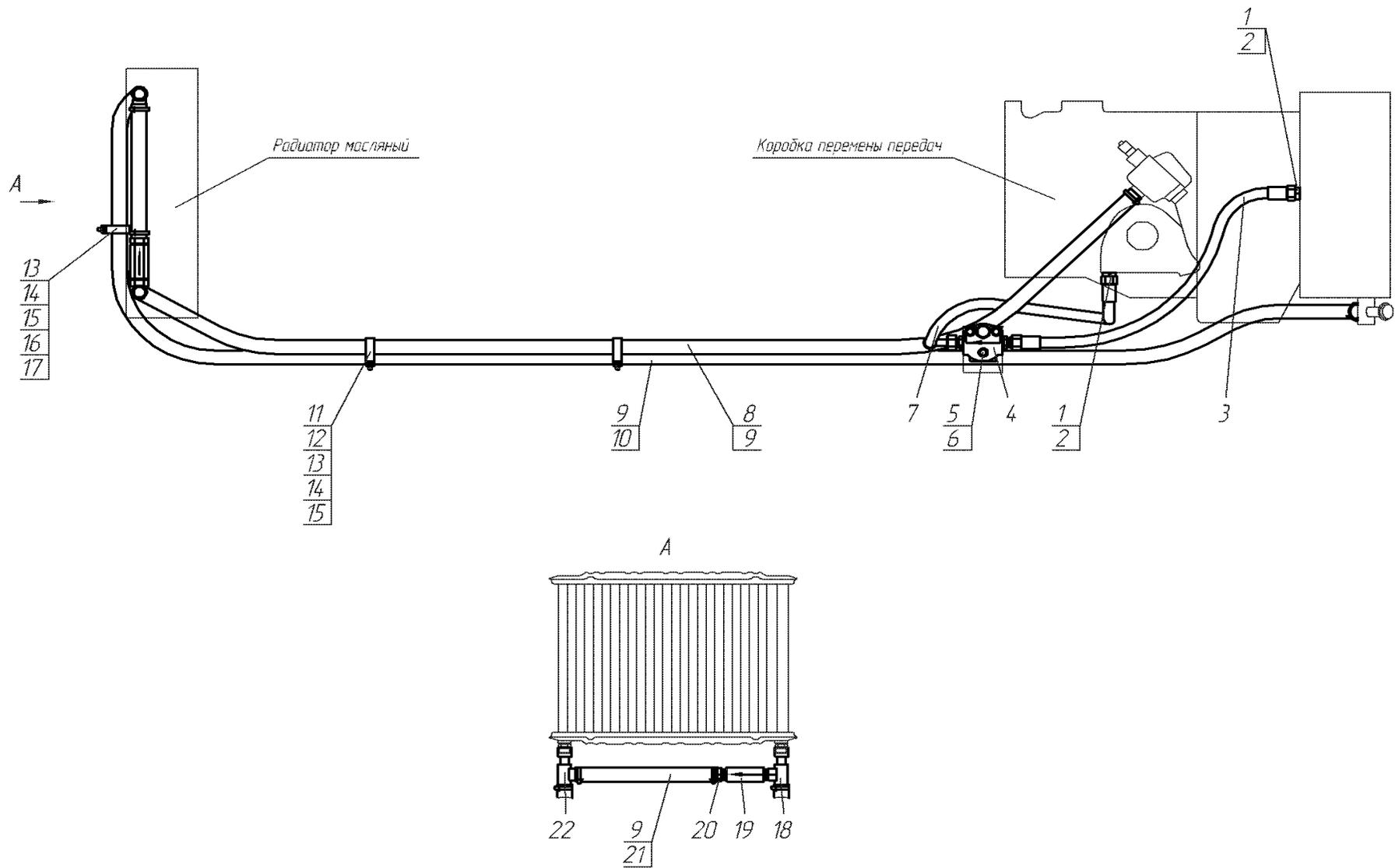
Рис. 31 Гидросистема КПП 752.12.00.00.000
