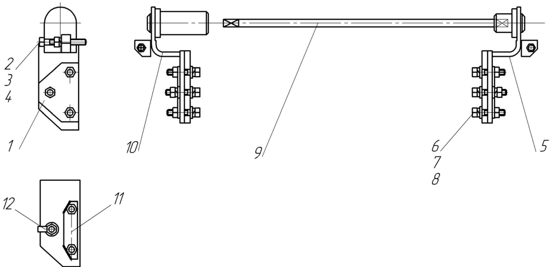
Рис.22 271.25.18.00.000 Установка торсиона
