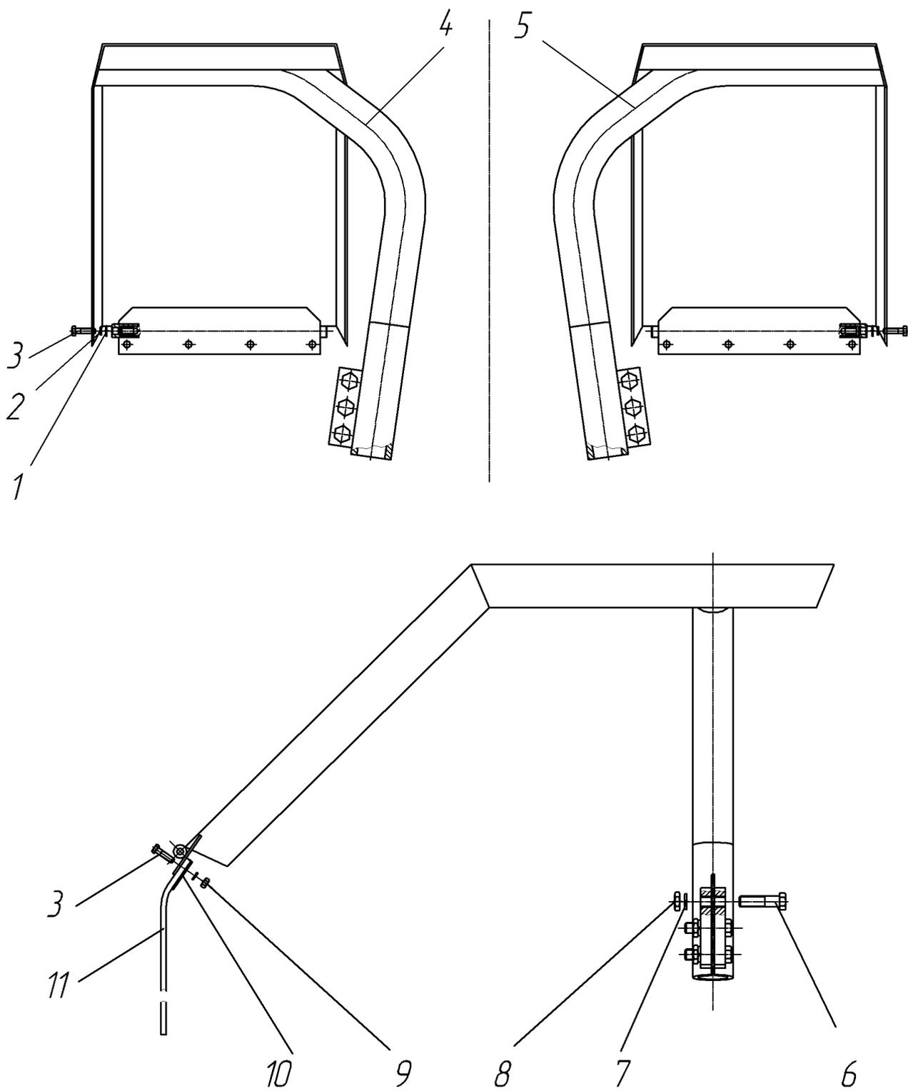
Рис. 24 Установка передних крыльев 237.47.00.00.000
