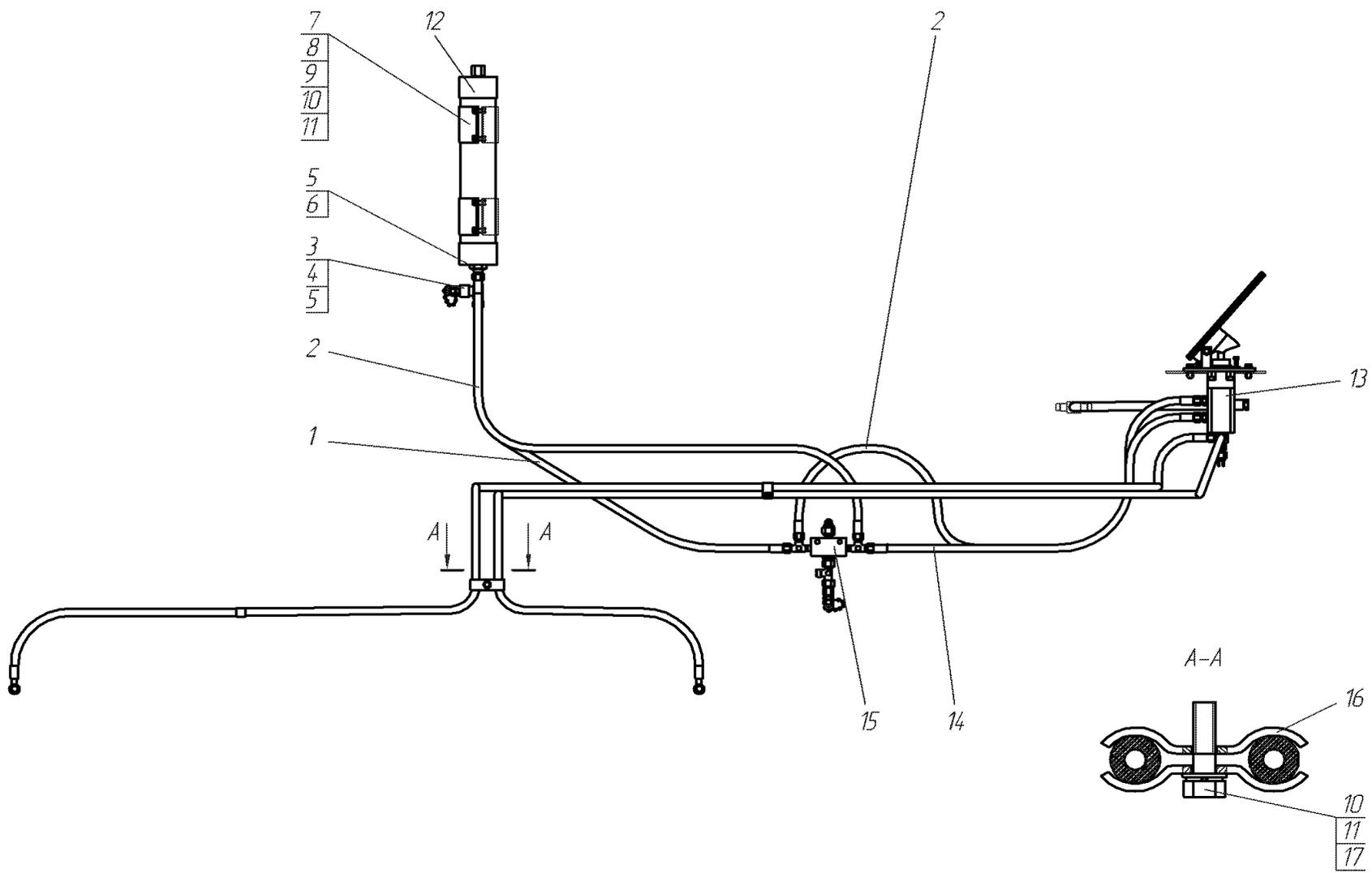
Рис. 30.1 Гидросистема тормозов 752.11.00.00.000
