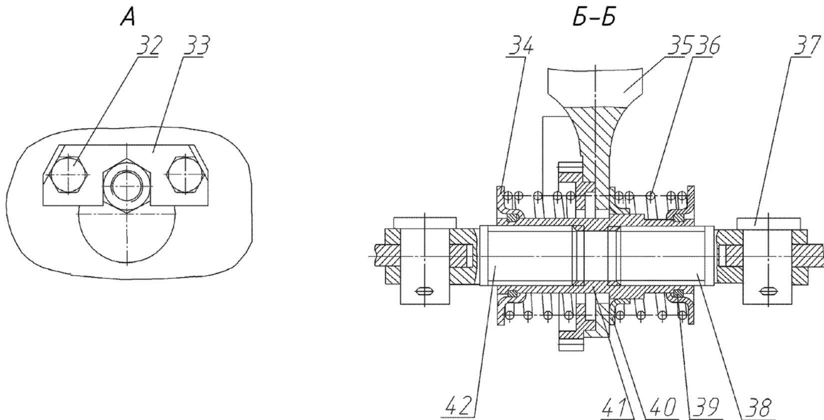
Рис. 52.2 Тормоз задних колес 248.03.06.00.000-01
