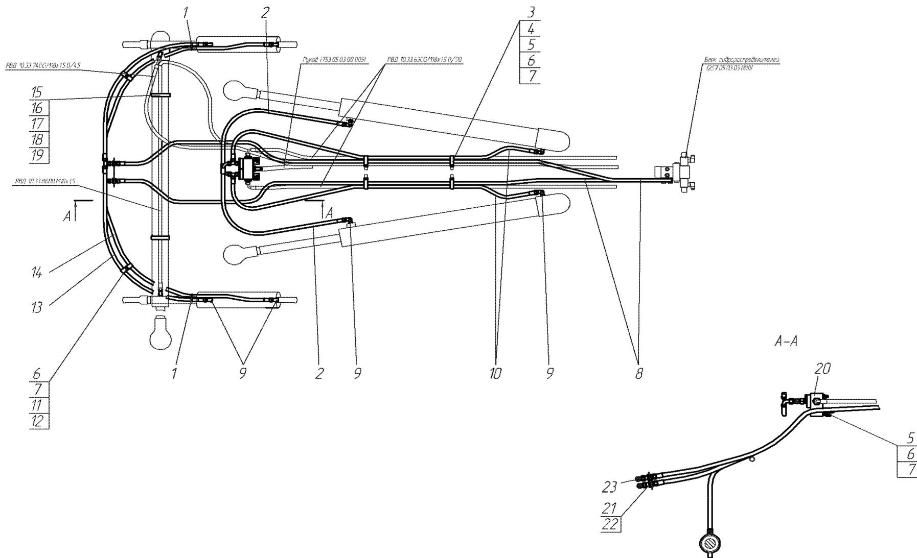
Рис. 29.1 Гидросистема рабочего оборудования 724.05.04.00.000-01
