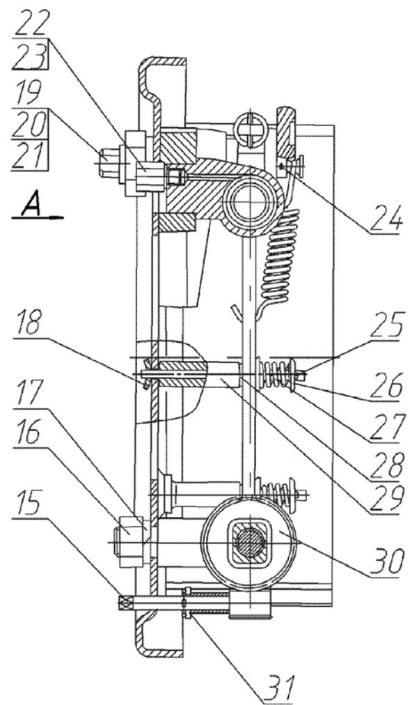
Рис. 52.1 Тормоз задних колес 248.03.06.00.000-01
