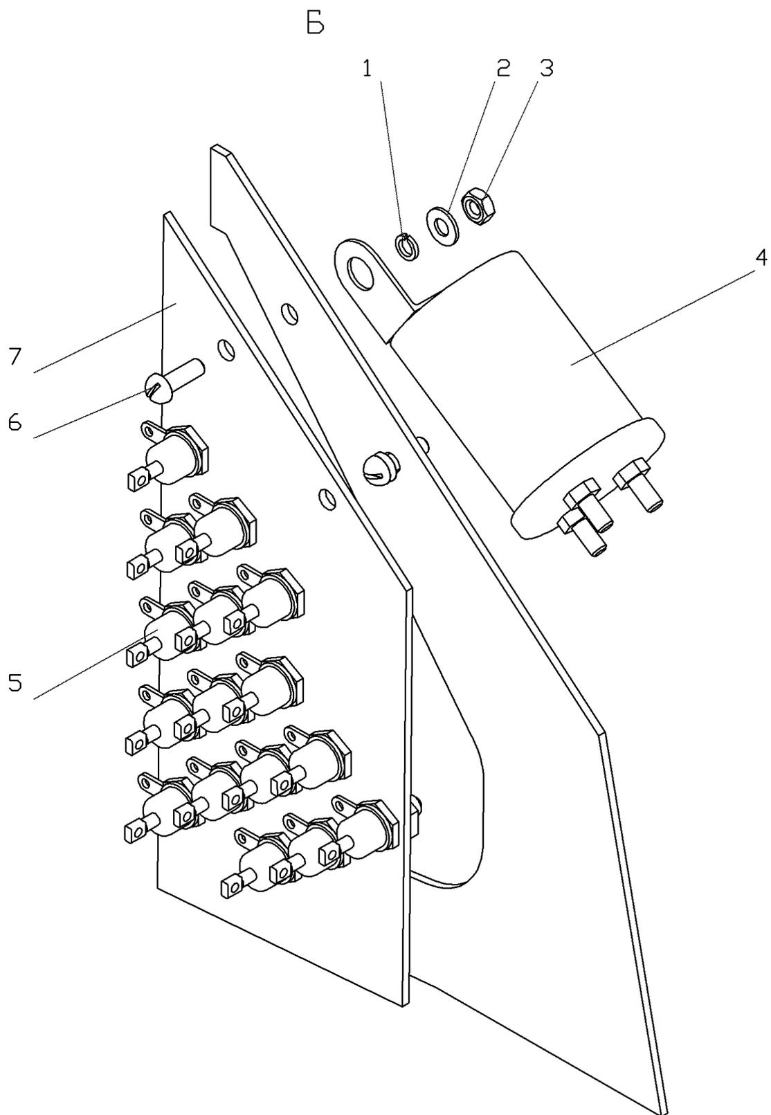
Рис. 16.6 Установка платы диодной 751.09.05.00.000
