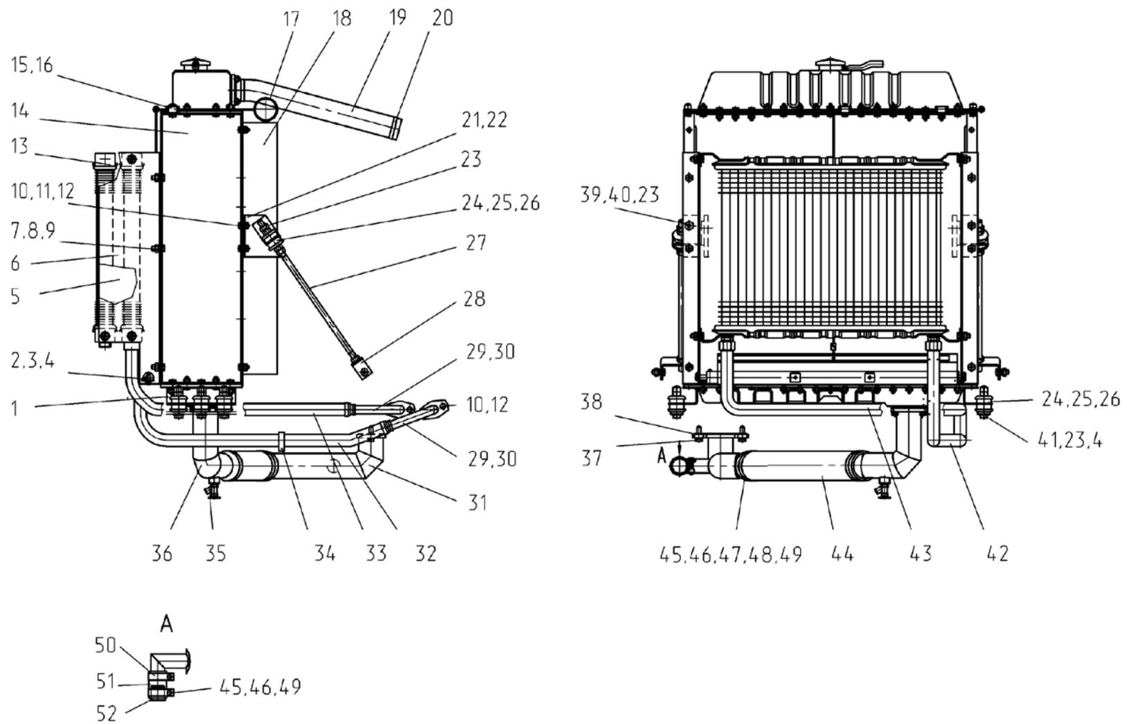
Рис. 34 Система охлаждения 237.02.01.00.000
